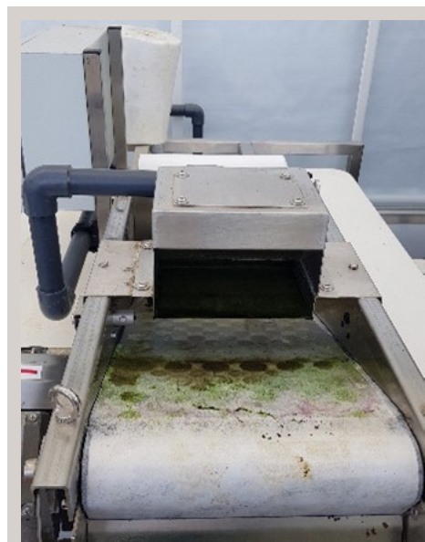
Figuur 3: Doekfilter voor filteren drainagewater.
